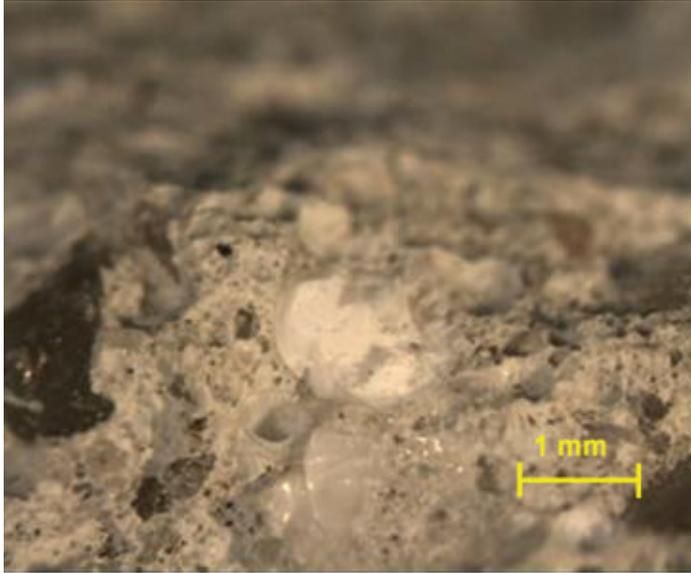
Figura 2.6. Concreto com RAS observado no Microscópio Ótico.
