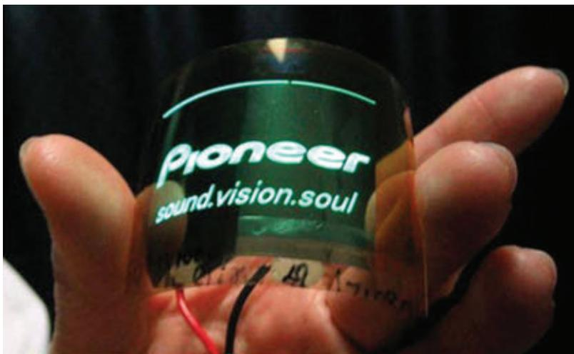
**Figura 4.** Luminescência de um OLED depositado sobre um nanocompósito flexível a partir de nanofibras de celulose provenientes de madeira.<sup>3</sup>
