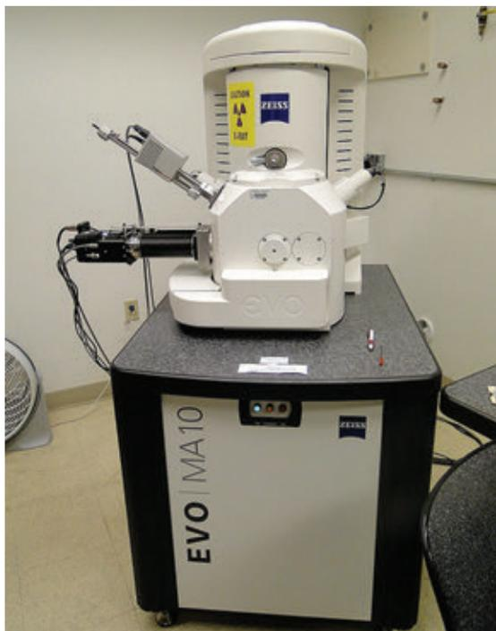
Figura 2.8. Microscópio Eletrônico de Varredura (MEV).
