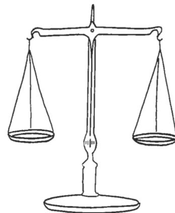
Se colocarmos pesos diferentes em cada prato da balança, o fiel acusa a diferença entre os pesos, ficando inclinado e apontando para o peso mais leve.
