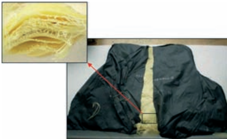
Figura 64. Detalhes do tecido balístico em camadas sobrepostas, formando o painel.
