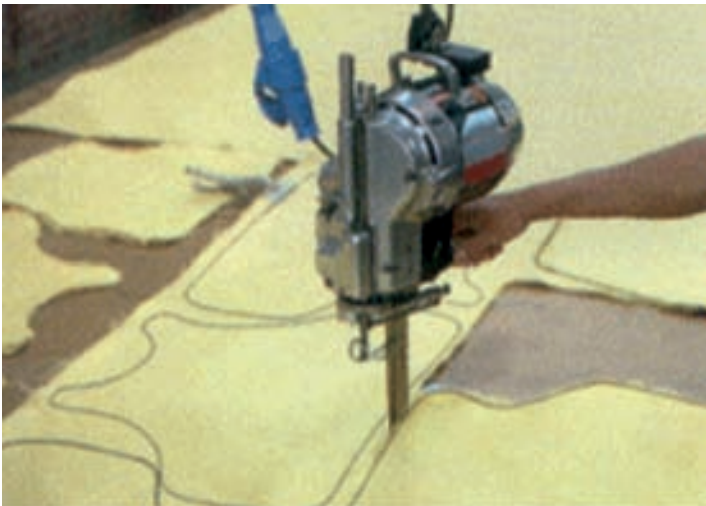
Figura 62. Camadas de material balístico sobrepostas sendo cortadas com máquina de costura industrial. Fonte: CBC.
