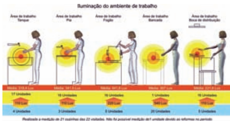
Figura 25. Medida da iluminação encontrada em determinada função.
