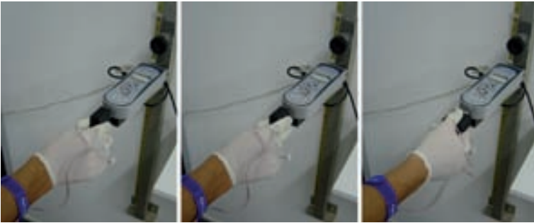
Figura 20. Equipamentos de avaliação e os tipos de preensão digital avaliados (da esquerda para a direita: bidigital, tridigital e pulpo-lateral).
