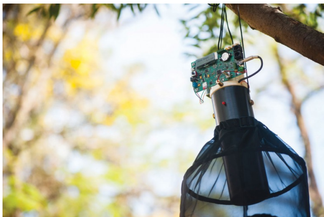
Protótipo da armadilha: 99% de acerto na identificação do Aedes aegypti
