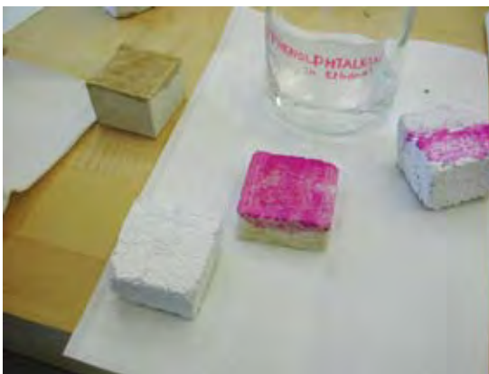
Fig. 2.14 – Controle de cura das amostras através de banhos periódicos com água, e posterior teste com fenolftaleína. Instituto de Conservação Getty.
