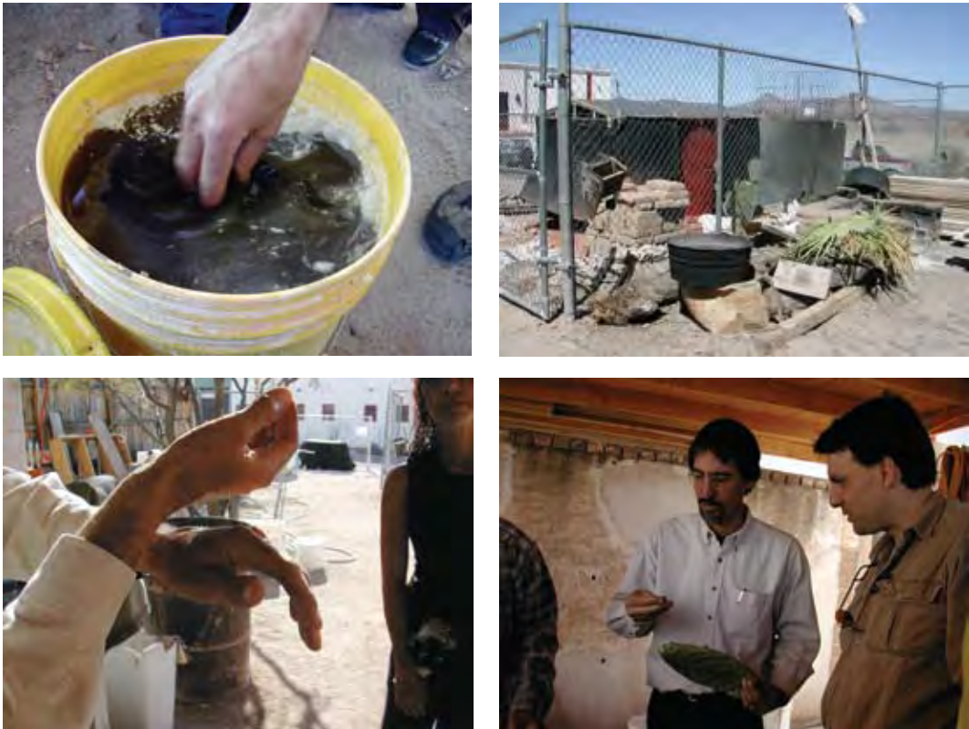
Fig. 3.9 – Mucilagem de cactos nas argamassas de reconstituição. Ig.San Xavier del Bac, EUA.
