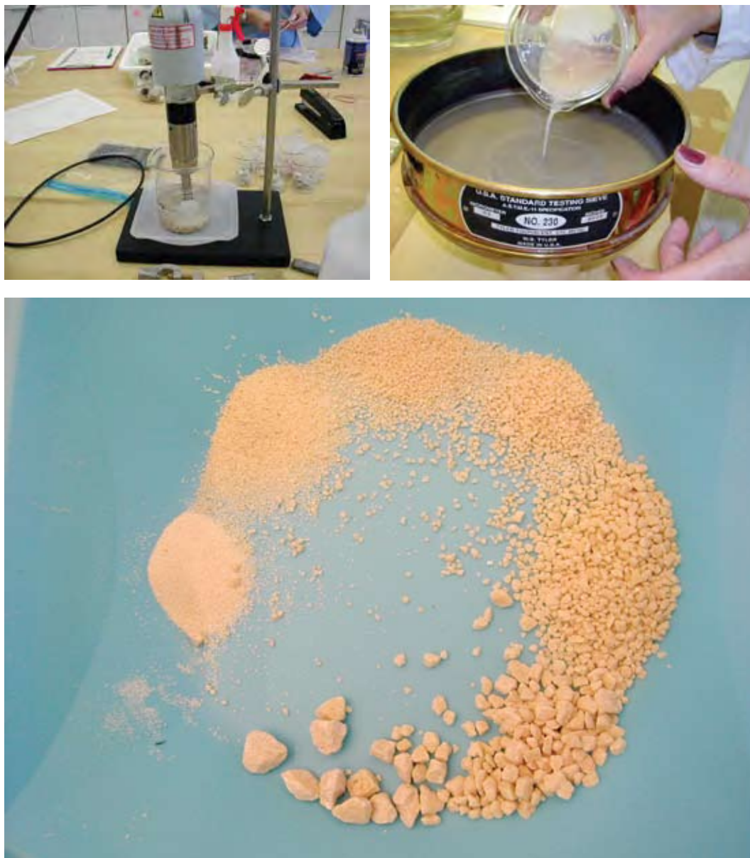
Fig. 2.4. – Equipamento em “teste” para separar o aglutinante do agregado composto de partículas carbonáticas. Instituto de Conservação Getty.
