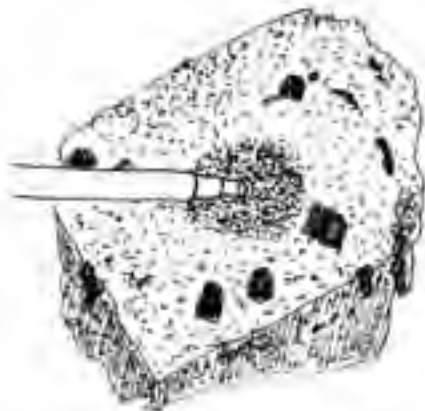
Fig. 2.2 – Passos iniciais para analisar argamassas antigas: observar in loco , observar com lupas, documentar, observar absorção de água; se possível, usar microscópio.
