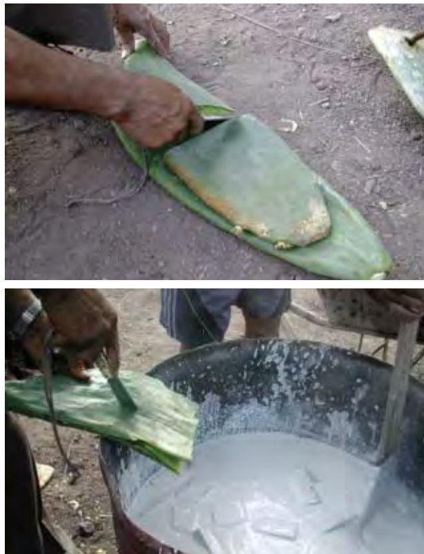
Fig. 4.13 – Caiação preparada hidratando cal virgem com pedaços de cactos. O calor ajuda a soltar melhor a mucilagem e se misturar com a cal. Putaendo, Chile.
