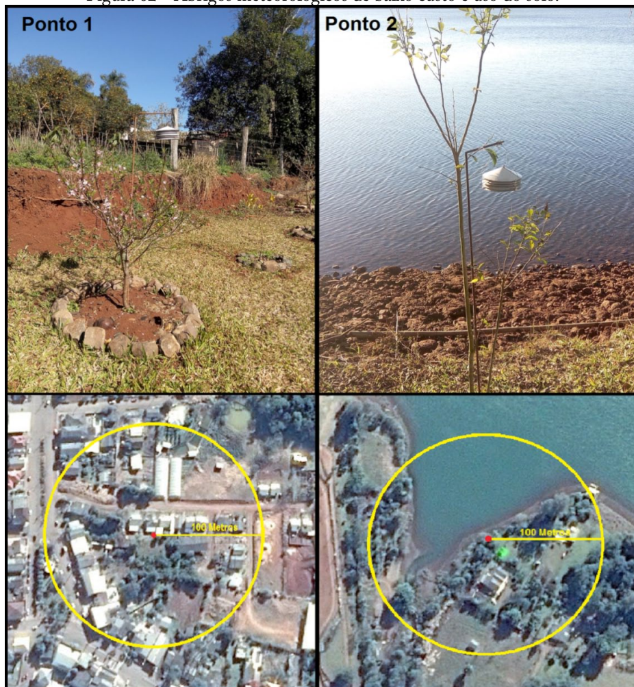
Figura 02 - Abrigos meteorológicos de baixo custo e uso do solo.
