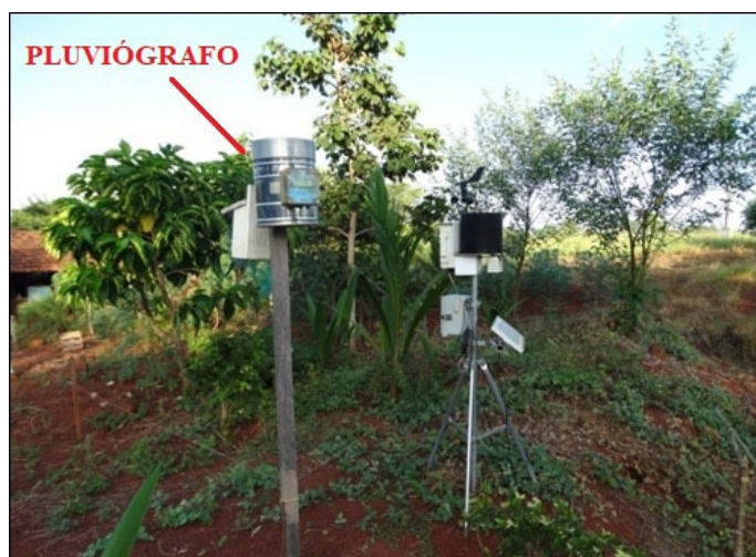
Figura 2- Pluviógrafo instalado no ponto P6.
