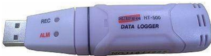
Figura 3 - Datalogger HT-500 Instrutherm Equipamento utilizado para obtenção dos dados de temperatura e umidade relativa do ar.
