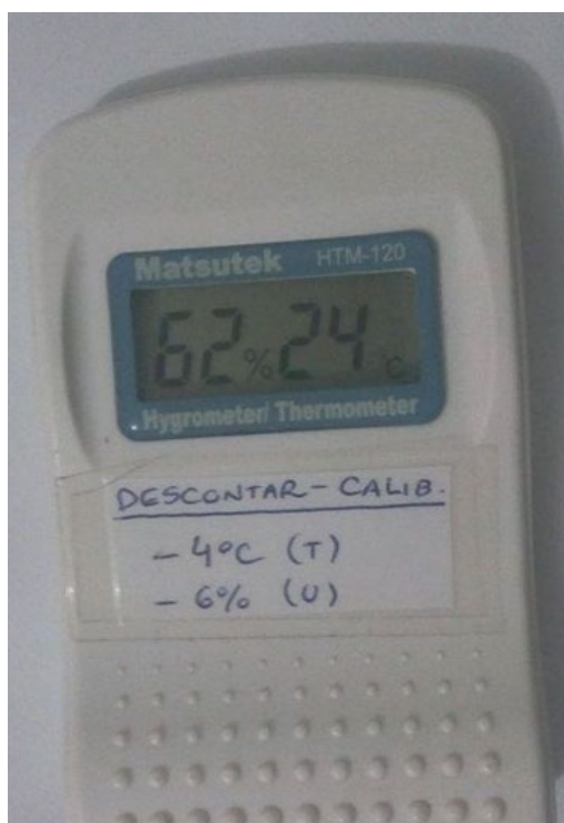
Figura 05 - Termômetro eletrônico MATSUTEK HTM120
