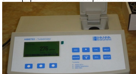
Fotografia 6 - Equipamento utilizado para a leitura de turbidez
