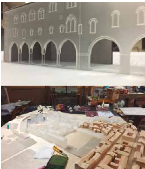
Figura 7: fasi del plastico in costruzione. In alto la facciata del Palazzo del Capitano, realizzata in plexiglass opaco, inciso con tecnica laser. In basso allestimento del modello generale con diversi materiali (legno ad indicare il contesto urbano, plexiglass per palazzo Ducale, ecc)
