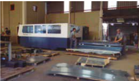
Figura 8: Produção dos componentes do pavilhão em cortadora a laser industrial. Fonte: Nomads.usp.
