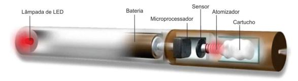
**Figura 1** – Interior do DEF Fonte: Adaptado de Fenner.
