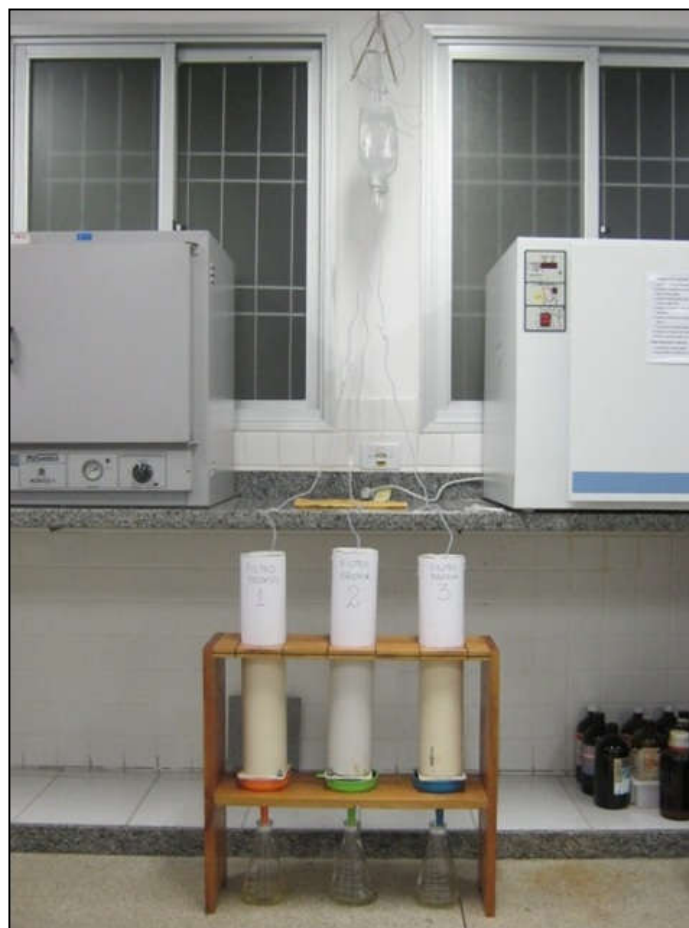
Figura 2. Permeâmetro montado em laboratório para realização do experimento de percolação.
