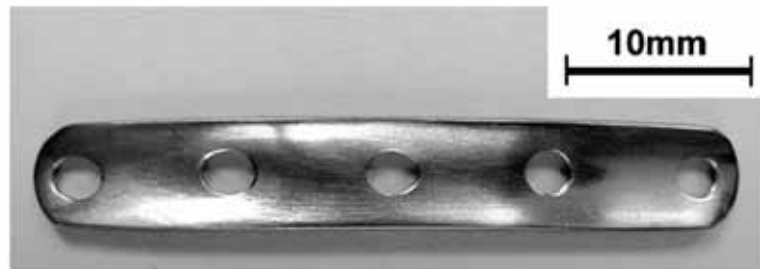
Figura 40 - Vista general de la microplaca de titanio cedida por la empresa Baumer [84].
