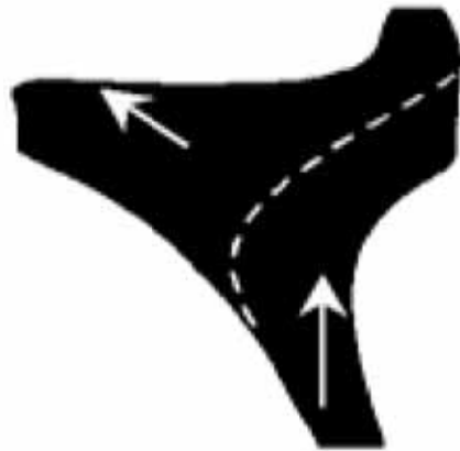
Figura 28 - Esquema ilustrando la sección transversal de la rueda entre el disco y el alojamiento del rodamiento en la región C. Las flechas ilustran la dirección de propagación de la grieta [68].
