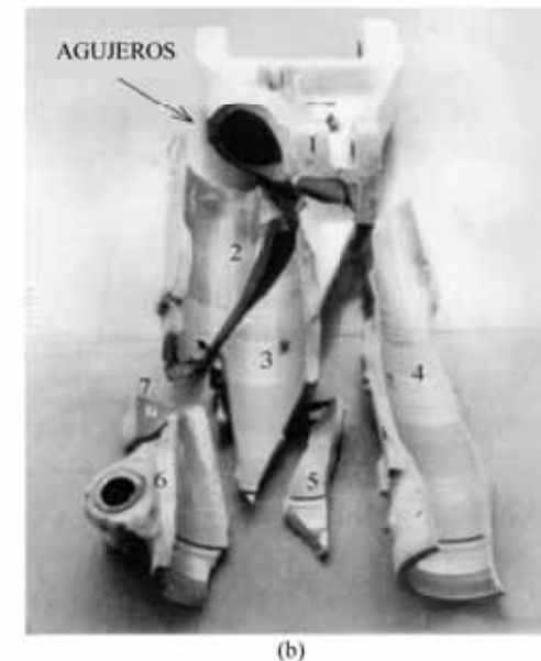
Figura 9 – (a) Esquema del cilindro externo del tren de aterrizaje del Fokker 100, mostrando la posición de dos agujeros en la parte superior del cilindro; (b) Cilindro externo del tren de aterrizaje fracturado en siete fragmentos en la condición como recibido [21].
