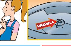
COLOQUE O REGULADOR NA POSIÇÃO VERTICAL SOBRE A VÁLVULA DO BOTIJÃO.
