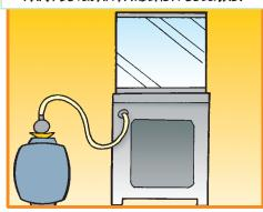
SE A DISTÂNCIA FOR PEQUENA E O BOTIJÃO ESTIVER NA ÁREA DE SERVIÇO, NA MESMA POSIÇÃO DO FOGÃO, PODE-SE PASSAR A MANGUEIRA ATRAVÊS DE UM TUBO DE PLÁSTICO, COM FOLGA PARA NÃO INTERFERIR NO EVENTUAL MOVIMENTO PARA A LIMPEZA DO FOGÃO!
