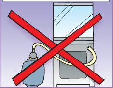
SE NECESSÁRIO, TROQUE A CONEXÃO DE ENTRADA DO FOGÃO PARA O LADO OPOSTO OU CHAME UM TÉCNICO ESPECIALIZADO PARA ESTUDAR A MELHOR SOLUÇÃO!
