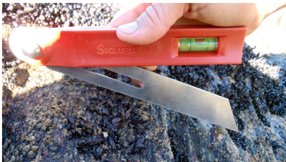
Figura 13-2. Detalhe de um inclinômetro medindo a inclinação de um costão. Foto: R.M. da Rocha
