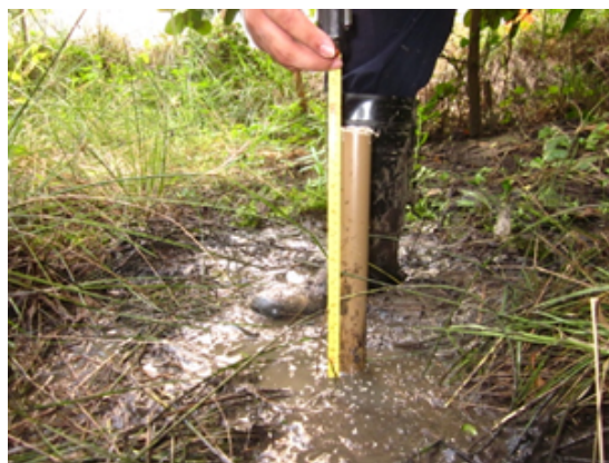
Figura 7-4. Mensuração de estaca de sedimentação. Foto: Clemente Coelho-Jr.
