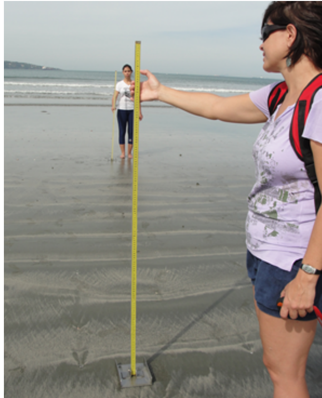
Figura 14-II-2. Exemplo de medição de perfil praias, segundo método de Emery (1961). Foto: G.S.C. Monteiro
