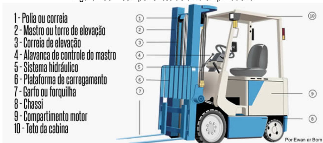
Figura 106 – Componentes de uma empilhadeira
