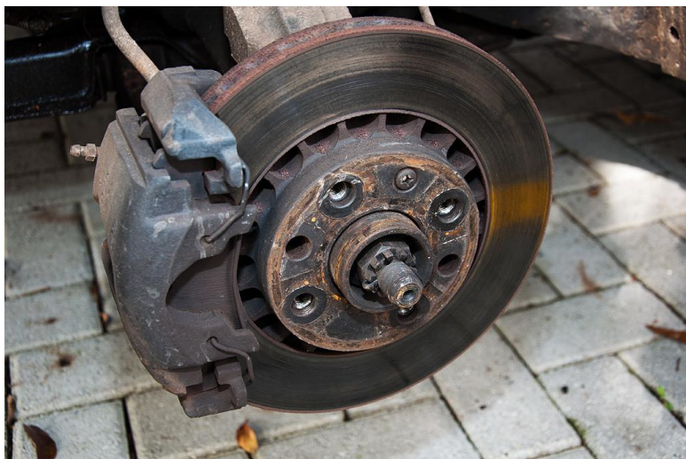
Figura 14 – Foto de um disco de freio acompanhado da pinça que contém as pastilhas de freio. É possível ver as ranhuras provocadas pelo atrito entre as pastilhas e o disco. Fonte: o autor
