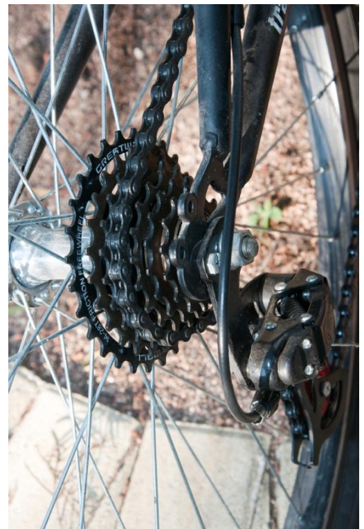
Figura 10 – Sistema de engrenagem de uma bicicleta. Fonte: o autor
