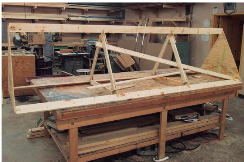
FIGURA 9 – Estrutura de Periakto para acabamento em tecido.
