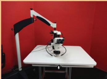
Mesa com cursor na horizontal e vertical que auxilia no posicionamento de coordenadas de deslocamento do material em análise
