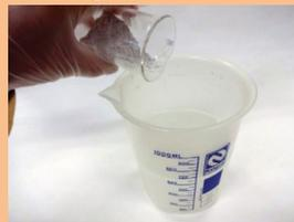
Solução de  $\text{H}_2\text{O}$  deionizada e  $\text{Ca}(\text{OH})_2$
