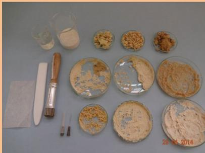
Obturação manual. Aplicação de pasta de celulose com agulha de injeção
