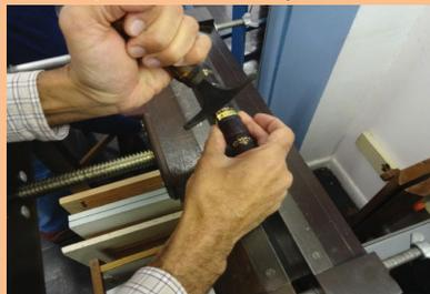
Vista geral da bombada após douração com ferro componedor
