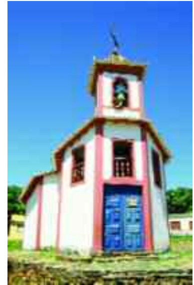
Acima. IGREJA DE NOSSA SENHORA DO Ó - SABARÁ (MG). Construída em madeira e taipa e com torre sineira na parte central da fachada, a capela é uma construção típica da fase primitiva da arquitetura na região mineira.
