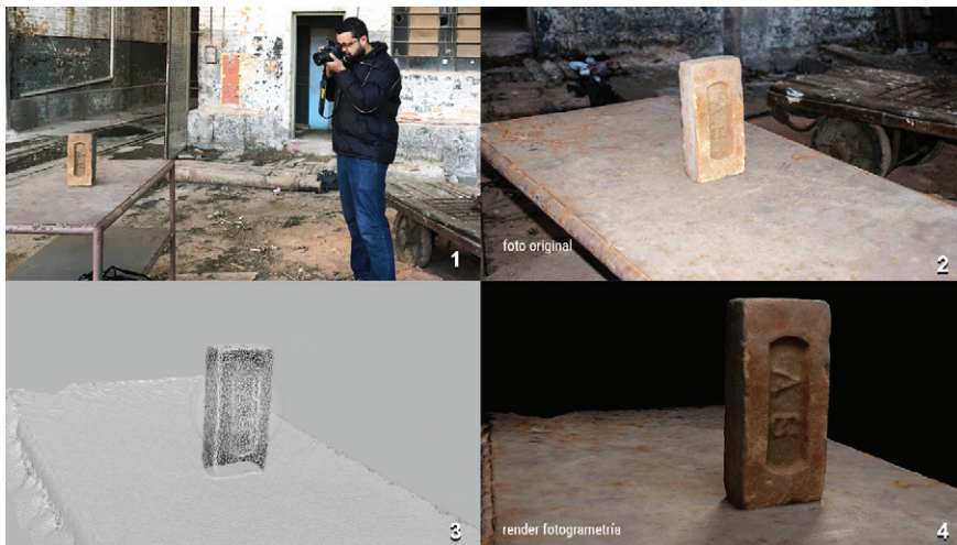
Figura 3: Passos no processo de registro fotogramétrico: levantamento fotográfico em anéis (1), uma das fotografias dos anéis (2), nuvem de pontos (3) e render fotogramétrico (4).
