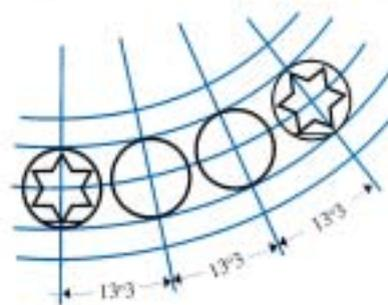
2º – Divida, com um outro círculo, a parte interna da bordadura em duas partes iguais. A intercessão deste círculo com os raios que dividem o escudo em 9 partes indica o centro das 9 primeiras estrelas que você vai inscrever na bordadura.
