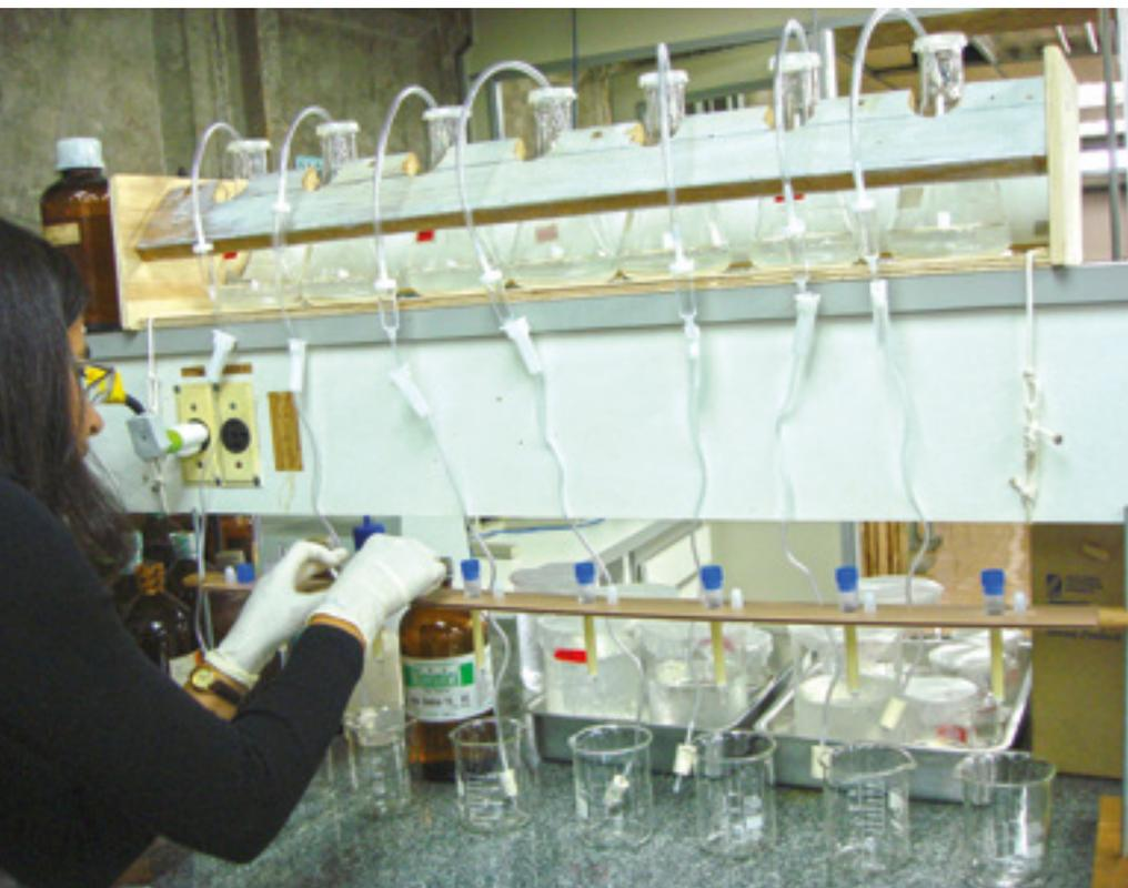
*Figura 2.21 - Preparação de amostras de água*
