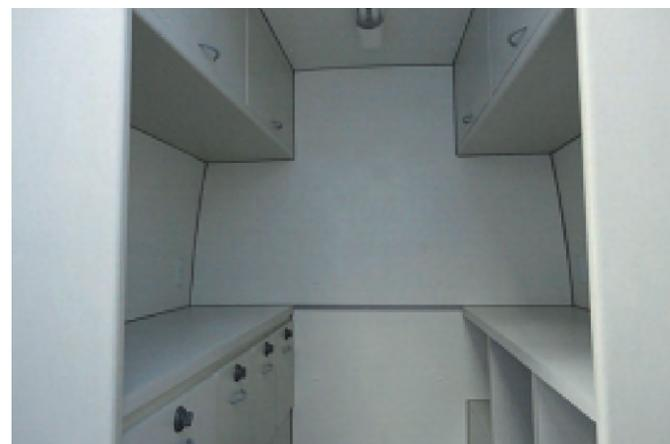
A parte traseira do veículo é projetada de forma que seja possível guardar os materiais a serem utilizados no campo – a partir do planejamento da equipe para as atividades do dia – e é equipada com tomadas com extensão, permitindo a utilização de equipamentos eletrônicos. Assim, o carro é “abastecido” a cada ida a campo, com os materiais e equipamentos, com base na necessidade do dia.
