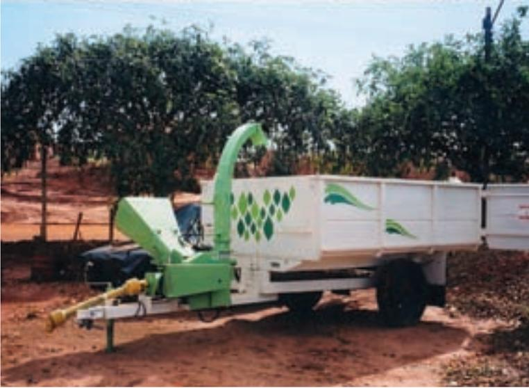
**FIGURA 2** - EQUIPAMENTO PARA PICAR GALHOS RESULTANTES DE PODAS DE ÁRVORES.
