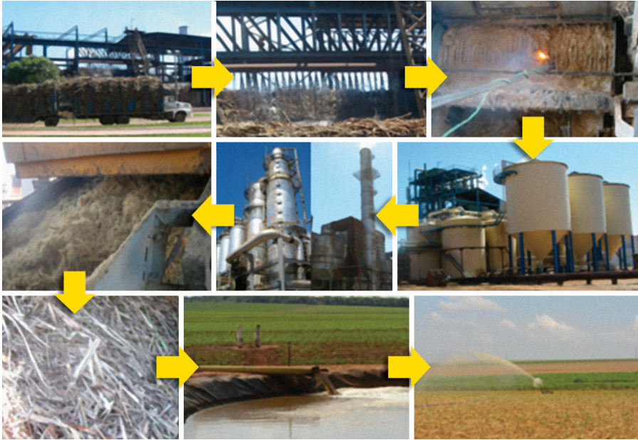
Figura 7 - Processamento da cana para fabricação de etanol. Na seqüência indicada: transporte da cana moída pela colheitadeira até a usina, seguida de lavagem em esteira. A cana moída é então prensada e separada em bagaço e caldo. O mosto segue para as dornas de fermentação e, posteriormente, o líquido fermentado é purificado na torre de destilação, e em seguida retificado. Como resíduos restam o bagaço e a palha (no canto inferior esquerdo), que são queimados nas caldeiras para geração de vapor e bioeletricidade, e a vinhaça, que pode ser acumulada em lagoas impermeabilizadas e usada para fertirrigação do canavial. Fotografias de Rodrigo Campanha.
