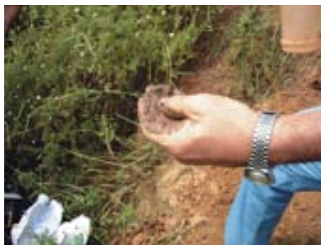
Foto 140 - Avaliação da textura em campo através do tato
