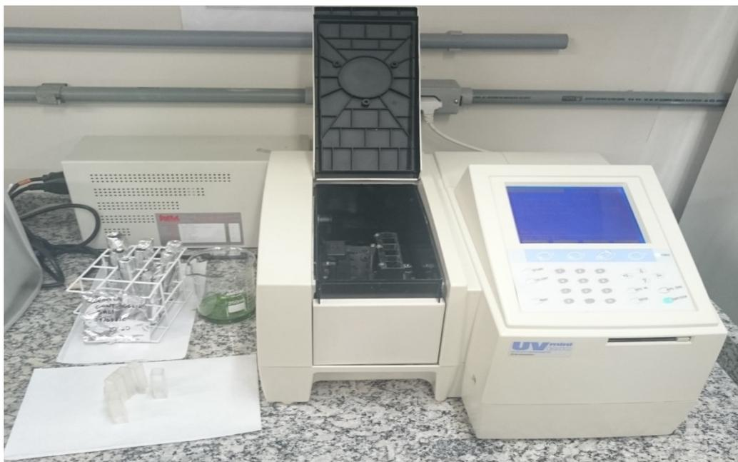
**Figura 11.4.** Leitura no espectrofotômetro. *Fonte:* Autores (2016).
