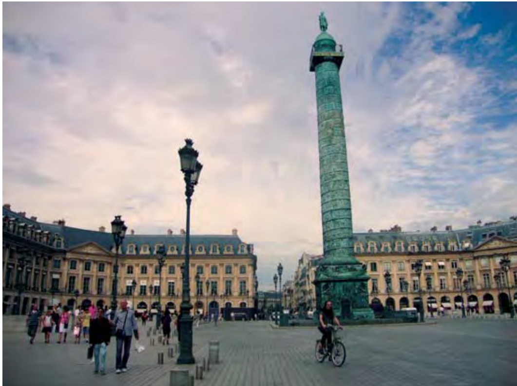
Pavimentação de via e praça niveladas para compartilhamento entre pedestres e veículos automotores. Place Vendôme, Paris. 2011. Foto: Sandra Bernardes Ribeiro.
