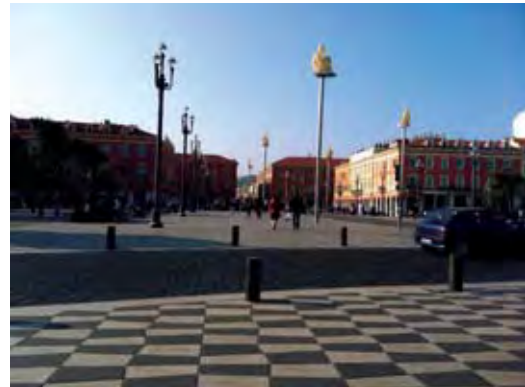
Pavimentação de praça e via no mesmo nível, com diferenciação do tipo de revestimento. Nice, França. 2011. Foto: Sandra Bernardes Ribeiro.
