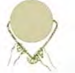
Fig. 2.20 – Medição do diâmetro com compasso de pontas curvas.
