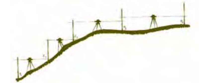
Fig. 2.23 – Nivelamento efetuado por meio de nível ótico e mira graduada.
