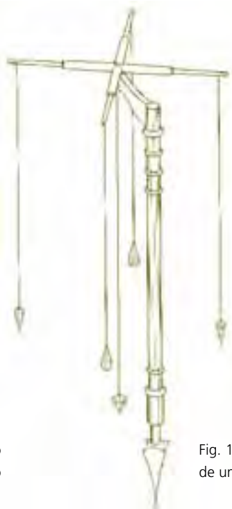
Fig. 1.6 – Reconstituição de uma dióptera, segundo Venturi (1814).
