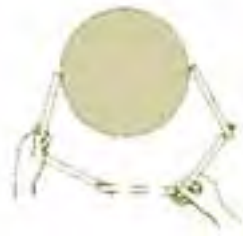
Fig. 2.18 – Medição do diâmetro com trena dobrável.
