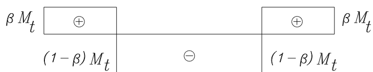
Figura 7.12- Diagrama de momentos de torção
