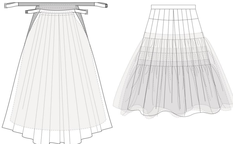
Figura 81 - Desenho técnico da saia longa com pregas e à dir.: detalhe da saia base com aplicação de 3 camadas de tecido franzido costurada na parte interna da saia longa com pregas.
