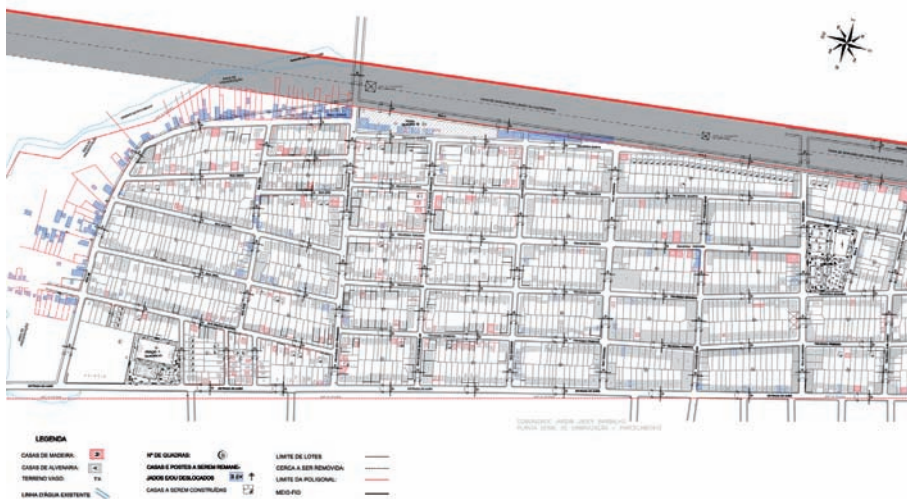
Figura 7 – Fac-símile de planta de urbanização do Jardim Jader Barbalho, em Ananindeua. Área de APP a ser preservada (traçado azul e vermelho, à esquerda), com remanejamento lindeiro (em azul), imóveis em madeira (em vermelho) e soluções convencionais de drenagem urbana, à exceção das margens do Igarapé das Toras e da permeabilidade do passeio
