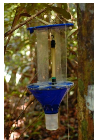
Figura 6. Armadilha luminosa para captura passiva de triatomíneos durante a noite.
