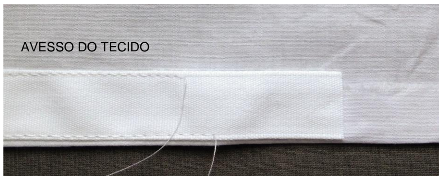
Figura 36 - Colocação do case específico para barbatanas na barra da peça. Foto: Isabel C. Italiano, 2018.
