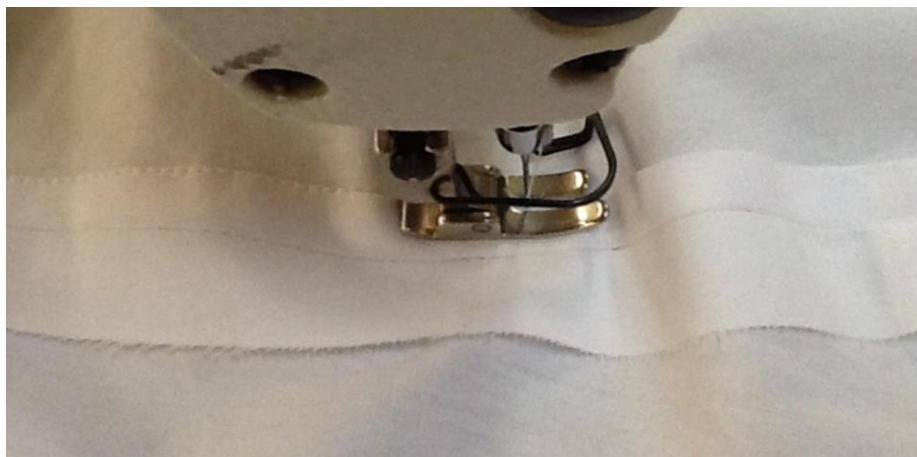
Figura 45 - Acabamento das costuras de união. Fonte: Acervo de Aglair Nigro Mello. Foto: Aglair Nigro Mello, 2017.
