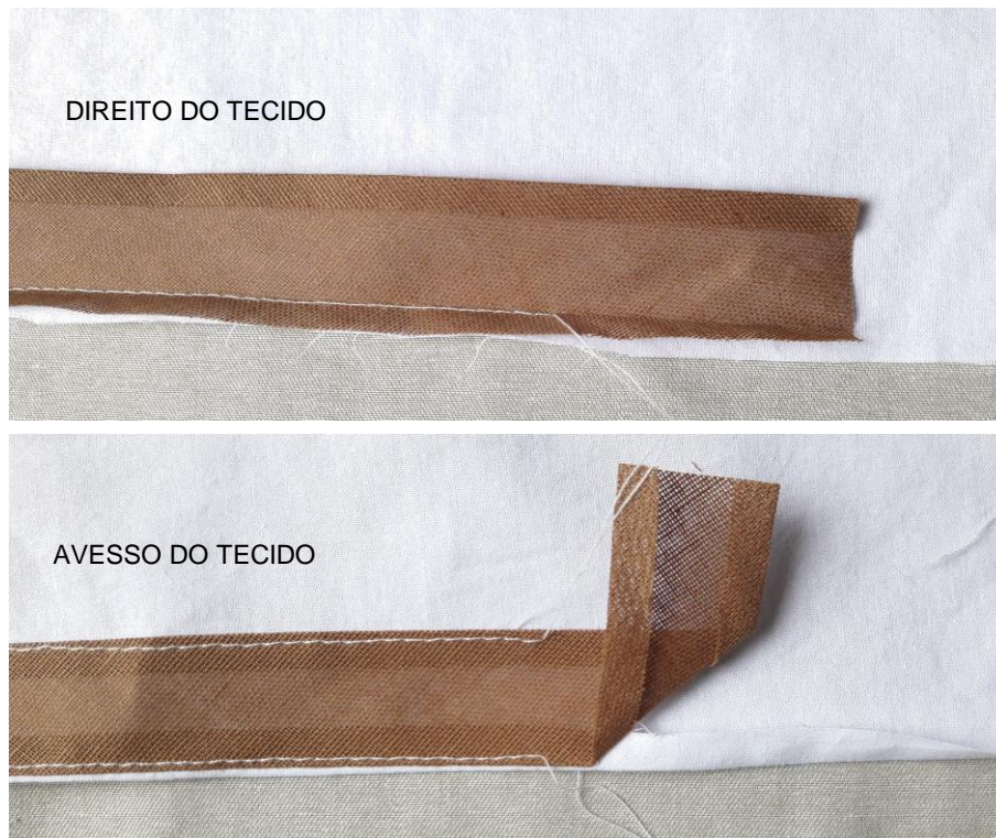
Figuras 33 e 34 - Colocação de canaleta de viés na barra da peça – primeira e segunda costuras. Foto: Isabel C. Italiano, 2018.
