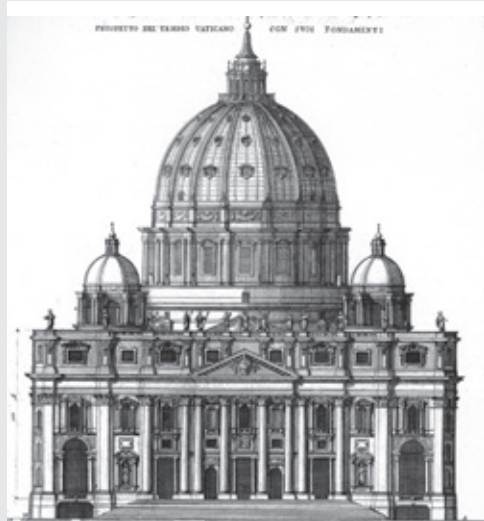
234. Elevação externa da Basílica de San Pietro, com destaque para a sua fachada principal, construída por Maderno, e para a cúpula projetada por Michelangelo e edificada por Giacomo della Porta após alterar o seu desenho, elevando a altura da estrutura. Imagem retirada do livro que Carlo Fontana escreveu sobre San Pietro – desenhos de Specchi. Fonte: Fontana (2003, p. 210).
