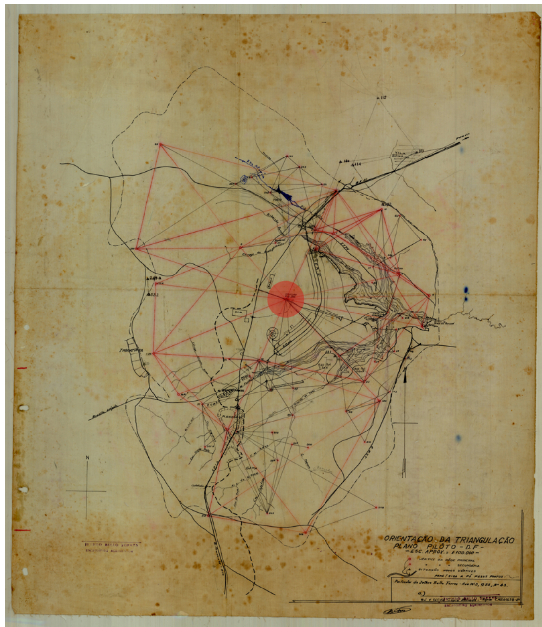
16 Orientação da triangulação Plano Piloto – D.F. esc. aprox. 1:100.000, s/d. Jethro Bello Torres, eng. agrimensor. Cruzeiro | V8 – assinalado a vermelho (CEEUM, 2014) Fonte ArPDF
