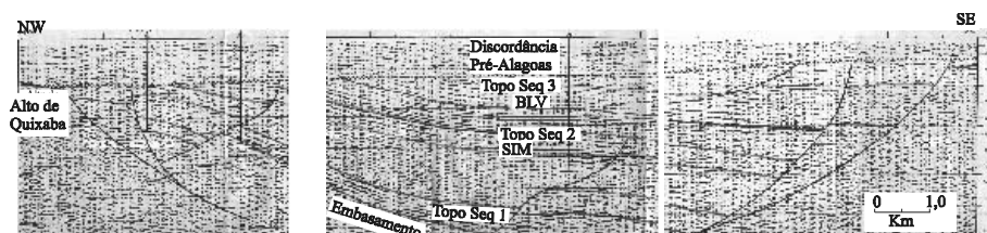
Figura 5.4 – Seção sísmica paralela à seção geológica anterior. Observe o caráter forte e contínuo das reflexões no topo da Seqüência 2 e em toda a Seqüência 3.
