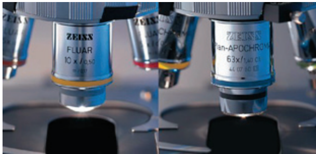
Figura 7: Objetivas de Fluorita (semi-apocromáticas) e Plan-apocromática.
