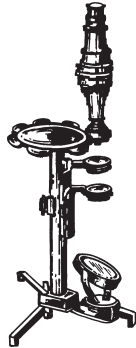
Figura 3: O microscópio “inovador” de Sir George Adams (cerca de 1746).
