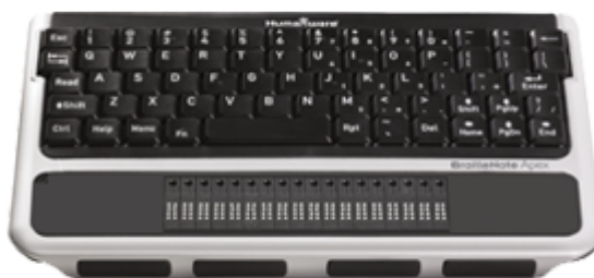
Figura 55 - Linha Braille. Dispositivo de input (alfanumérico) e output (braille) de dados. Fonte: www.humanware.com .
