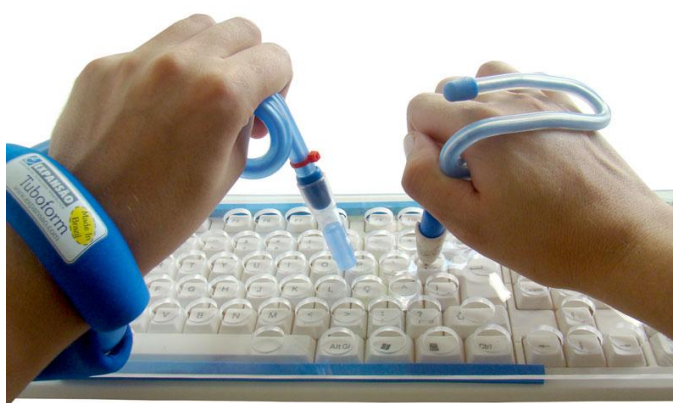
Figura 10 - Adaptadores de teclado permitem que usuários com restrições motoras possam acionar as teclas.
