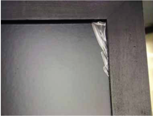
Figura 11 Deformação num laminado envelhecido no canto da fotografia
