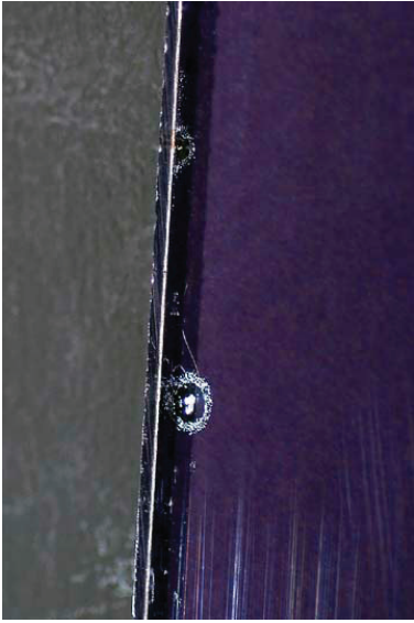
Figura 10 Detalhe de uma partícula de poeira durante a montagem: observe a auréola formada pelo levantamento em forma de tenda do adesivo sensível à pressão ao redor da partícula. Fotografia cortesia de Rynda Lemke
