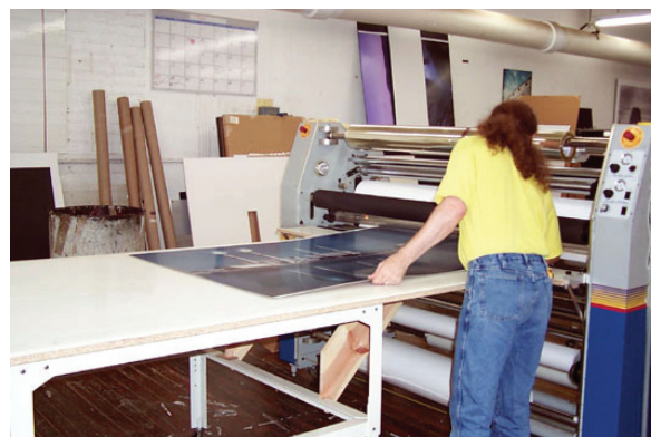
Figura 4 Fotografia passando por um rolo laminador no Photobition Chicago
