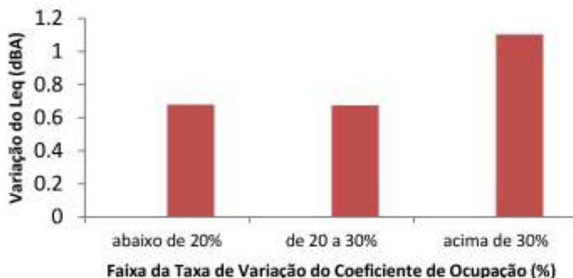
Figura 11. Relação entre a variação da taxa de coeficiente de ocupação e a variação de Leq(A) a 10 m (Mendonça, 2013)
