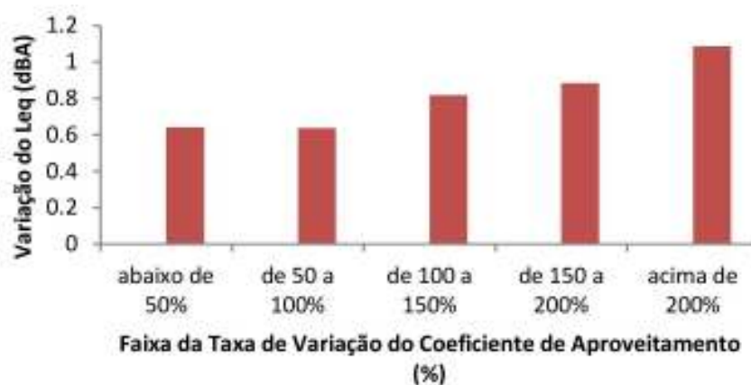
Figura 12. Relação entre a variação da taxa de coeficiente de aproveitamento e a variação de Leq(A) a 10 m. (Mendonça, 2013)
