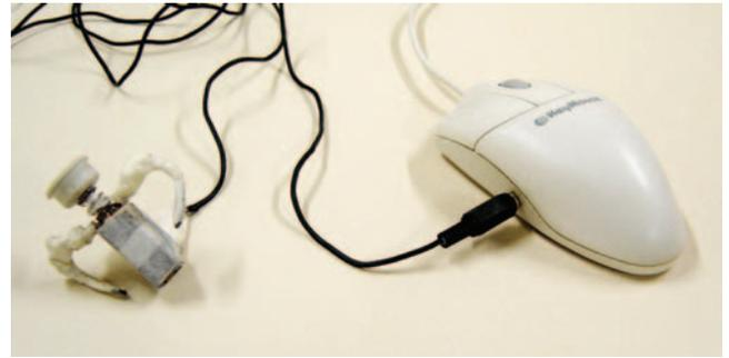
Foto 21 – Accionador confeccionado con un botón de encendido/apagado de ordenador
