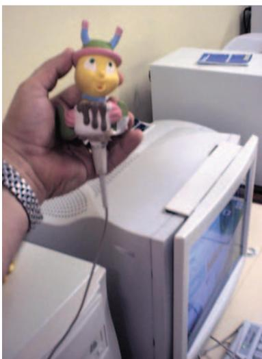
**Foto 18 - Micrófono con juguete de presión acoplado**
