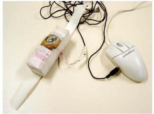
Foto 22 – *Switch* para accionar con la cabeza, hecho con un botón grande de material desechado
