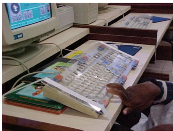
Foto 12 - Teclado con la inclinación modificada y fijado a la mesa
