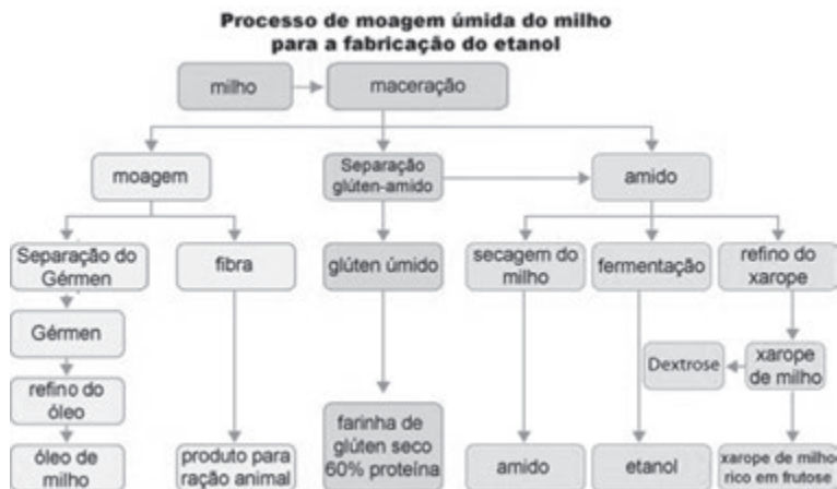
Figura 1 – Processo de moagem úmida do milho para a fabricação de etanol
