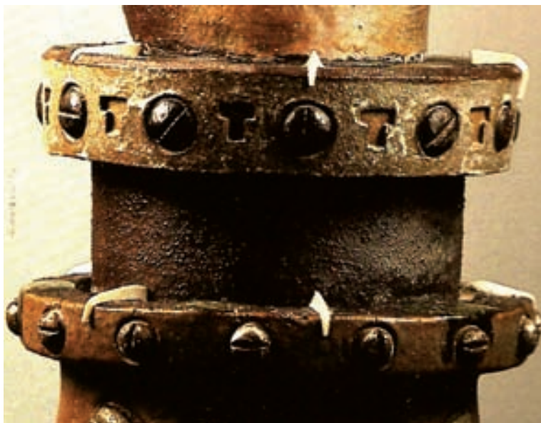
Figura 85 – Detalhe de base de escultura de Francisco Brennand, com a utilização de cones pirométricos (foto da autora).
