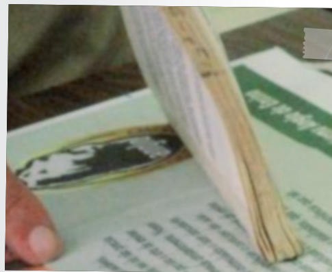
Retirando o excesso de cola da lombada e realinhando os cadernos
