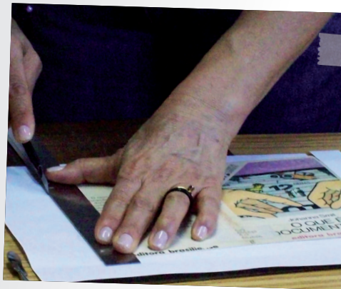
Cortar o excesso de papel, em volta da capa, com auxílio de régua de metal e estilete
