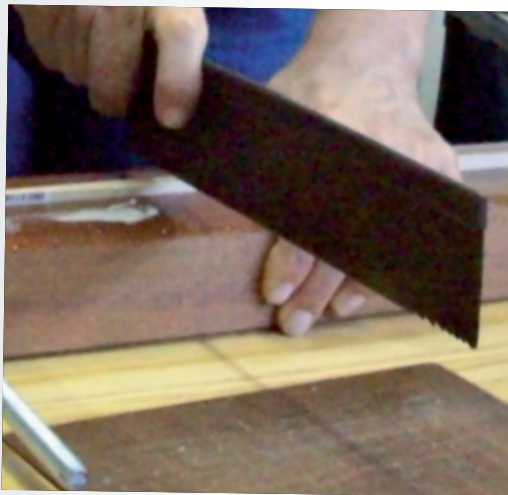
Com o serrote, fazer ranhuras em quatro pontos da lombada do livro, pelos quais será feita a costura
