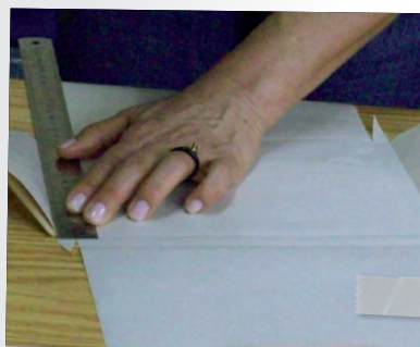
Com auxílio da régua e da dobradeira, marcar os vincos
