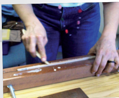
Espalhando cola de silicone, uniformemente, sobre a lombada
