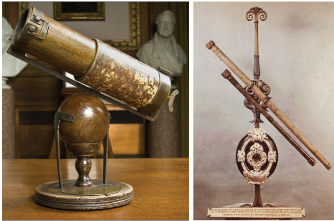
10- Telescópio refrator de Galileo (à direita) e telescópio refletor de Newton (à esquerda), dois dos primeiros telescópios construídos.
