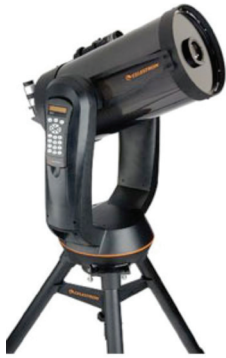
17- Duas montagens altazimutais. Em ambas, o movimento do telescópio se dá num eixo horizontal (de azimute) e num eixo vertical (de altura). O telescópio da esquerda é acionado por motores elétricos controlados por computador e o da direita é totalmente manual (crédito: Celestron).
