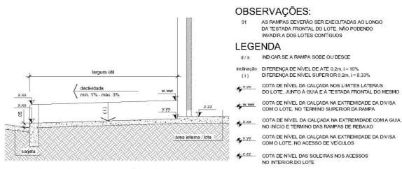
REBAIXO DE GUIA PARA VEÍCULOS (tipo D) - corte A-A
