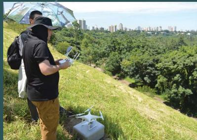
Levantamento aéreo feito com RAP (aeronave remotamente pilotada)
