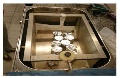
**Figura 12.6.** Beckers em agitador por um período de 24 horas. Fonte: Autores (2016).
