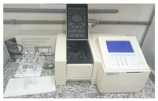
Figura 11.4. Lleitura no espectrofotômetro. Fonte: Autores (2016).
