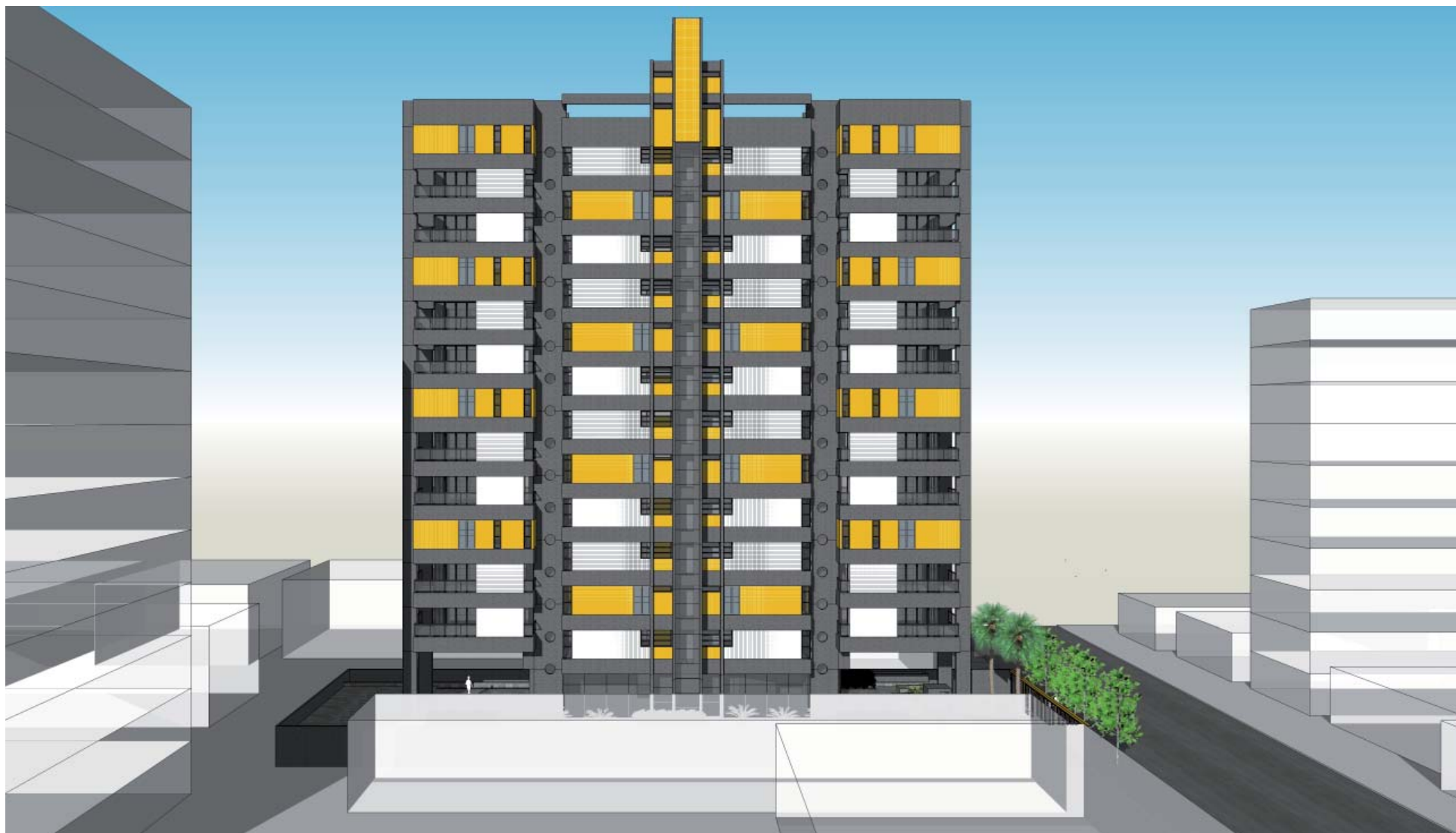
Edifício Mozart: face nordeste, destacando a cortina de vidro do elevador panorâmico e as janelas tipo “escotilha” das escadas privativas dos apartamentos. (BOSCARDIN, L. 2011)
