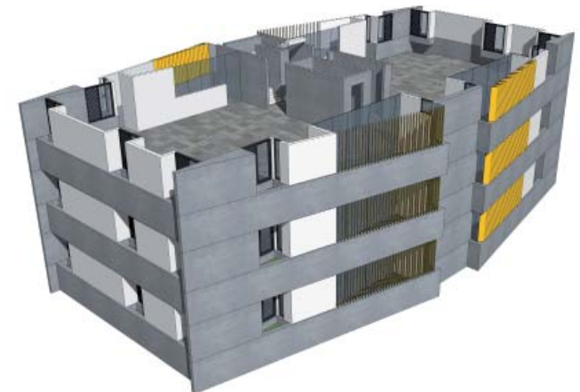
Edifício Maison. Componentes estruturais, fechamentos em alvenaria e caixilhos dos pavimentos tipo. (BOSCARDIN, L. 2011)
