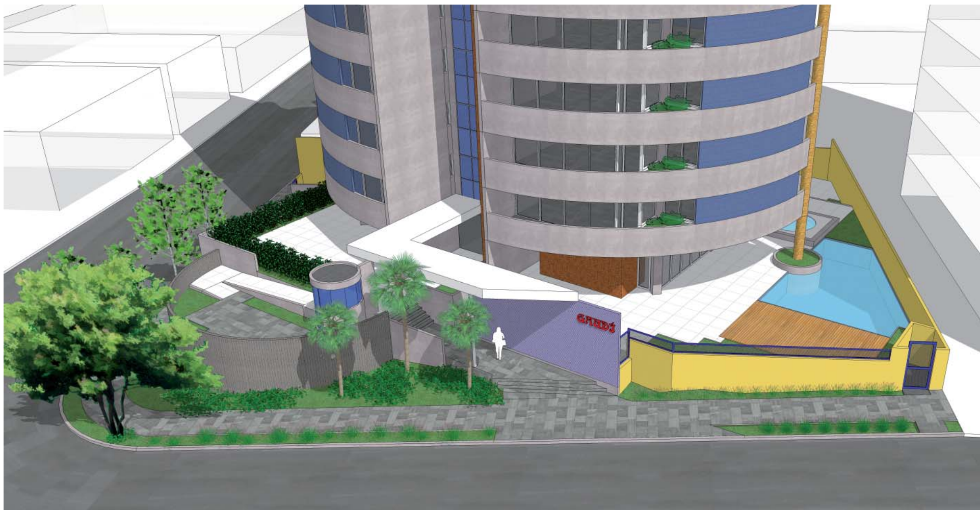
Edifício Gaudí: vista do embasamento, destacando o acesso de pedestres posicionado em ângulo de 45° em relação a testada do terreno. (BOSCARDIN, L. 2012)
