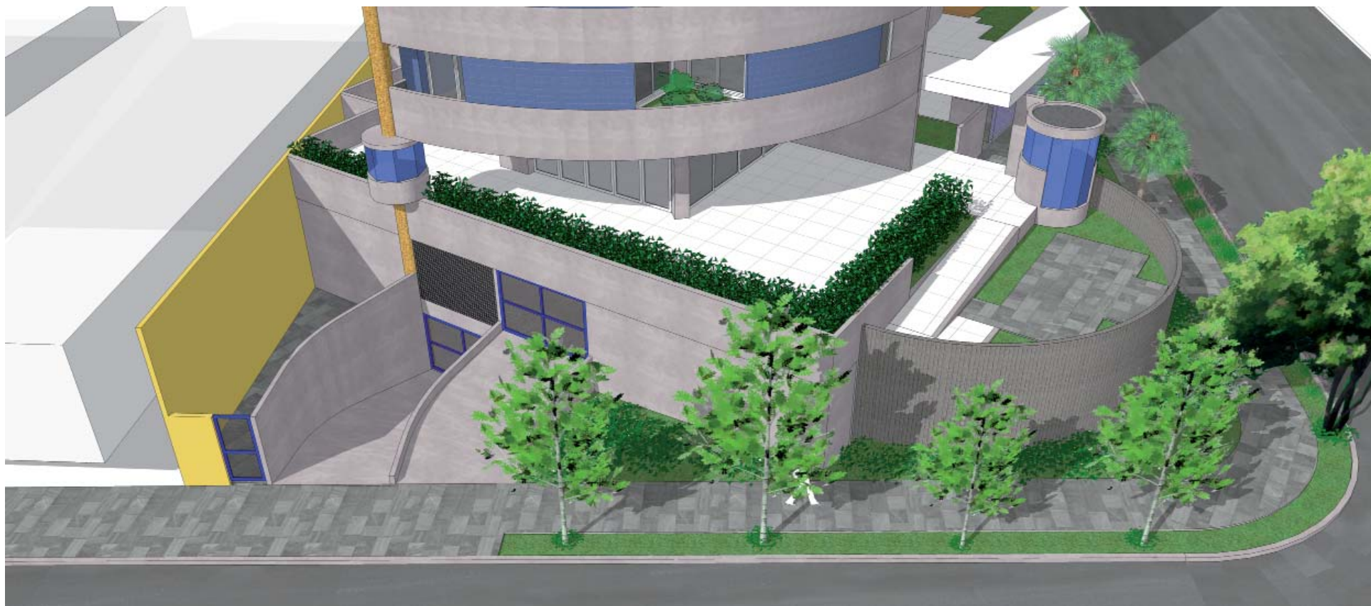
Edifício Gaudí: vista do embasamento, destacando os acessos independentes do 1° e 2° subsolos, tomando partido da inclinação da Rua das Paineiras. Notar o volume da guarita sobre as rampas, anexada ao pilar. (BOSCARDIN, L. 2012)
