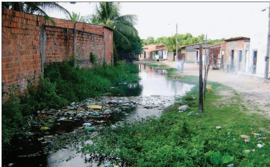
Figura 2.32 – A falta de infraestrutura, principalmente coleta de esgoto e lixo, e sistema de drenagem, se apresentam entre os principais problemas da comunidade Vila Velha.
